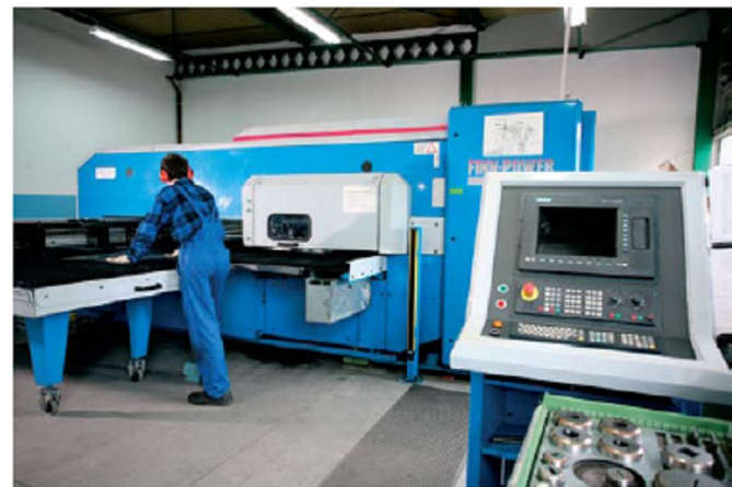
Stanowisko do wykrawania blach
