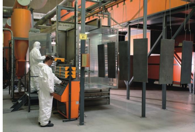
Linia malowania proszkowego
